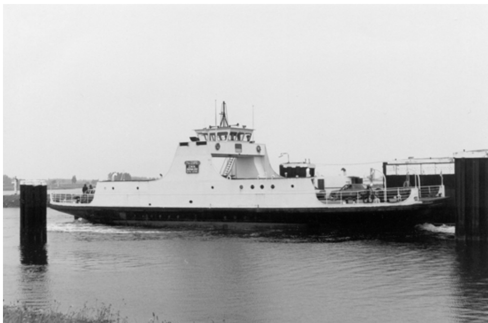
Op 28 augustus 1972 liep de motorveerboot Zijpe de haven van Zijpe binnen met een strak, eigentijds uiterlijk. De volgende dagen werden benut voor proefnemingen in de havens en aanpassing van de bruggen. De motorinstallatie was aanzienlijk lichter dan de verwijderde stoommachine plus ketels, zodat - ook na ballasten - het schip hoger op het water lag.
