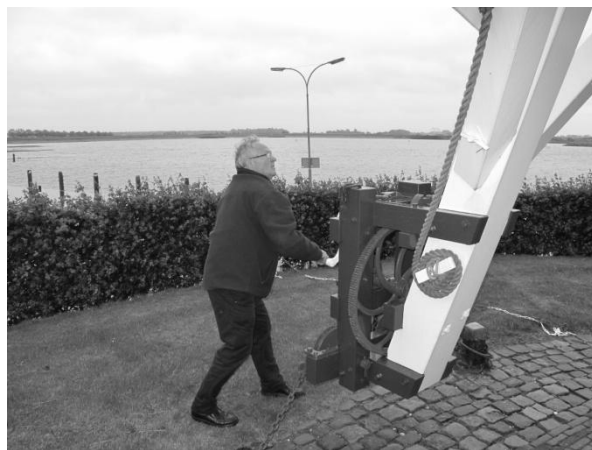
Molenaar Jan Reijngoudt aan het kruilier van de achterkante bovenkruier.
